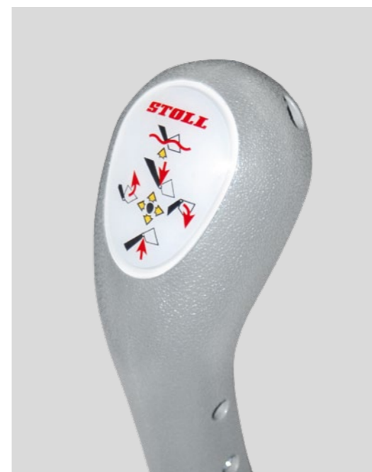
Az egykaros, Bowden-kábeles vezérlőegység ergonomikus kezelőkarja a vontatófülkéjében, a vezető kezei között található.
