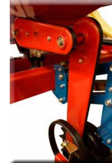
Antriebskassetten über Sporenrad
